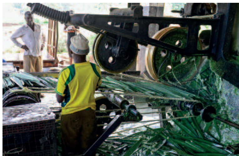
Diese Maschine löst die Fasern aus den Blättern.
